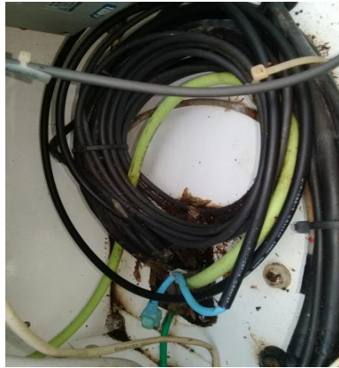
රූපසටහන 16 - ගාල්ලේ කාලගුණ විද්‍යා මධ්‍යස්ථානයේ පිහිටි AWS පද්ධතියේ Data logger හි කෘමි කොටස් රැදී ඇති ආකාරය
