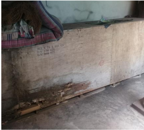
ත්‍රිකුණාමල කාලගුණ විද්‍යා මධ්‍යස්ථානයේ ස්ථාපිත කිරීමට නියමිත AWS පද්ධතියේ mounting pole ප්‍රධාන කාර්යාලයේ ගබඩා කර ඇති ආකාරය
